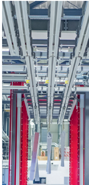
Das Fördersystem macht es möglich, Vor- oder Nachbearbeitungsplätze anzusteuern, ohne die laufende Produktion zu beeinträchtigen.
