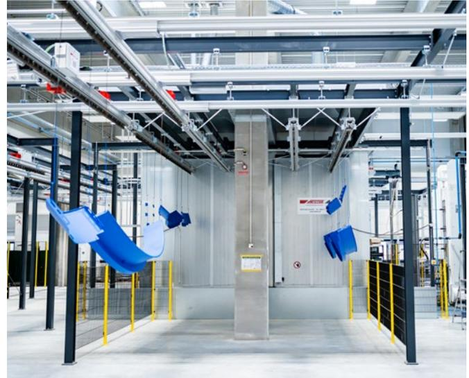
Nach dem Beschichtungsprozess werden die Teile unabhängig voneinander in den Pulvereinbrennofen gefördert und können dort individuell gestoppt und mit unterschiedlichen Geschwindigkeiten bewegt werden
