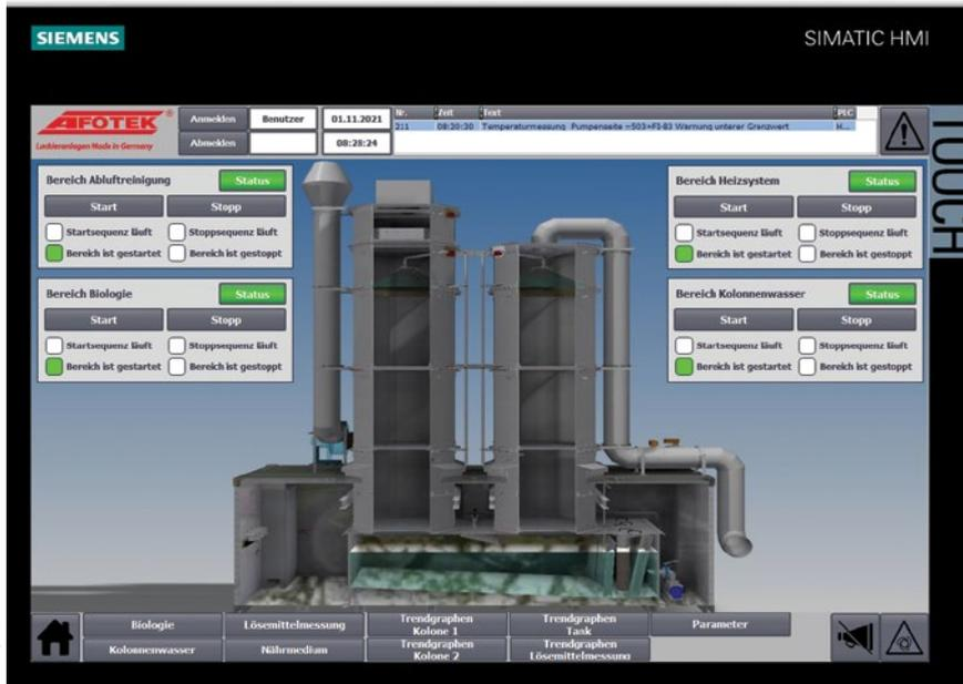
Die Anlagensvisualisierung wird mittels digitalem Zwilling in 3D dargestellt.
