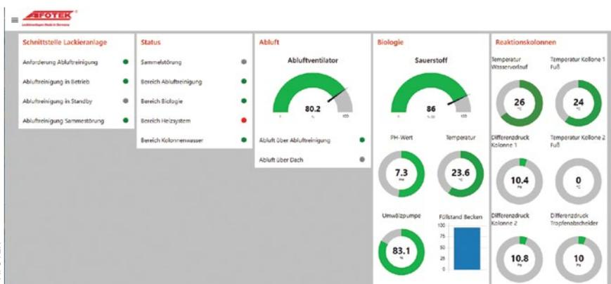
Das Dashboard ermöglicht die übersichtliche Anzeige der Prozessparameter von jedem Endgerät aus.
