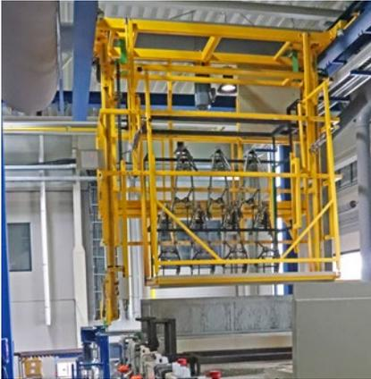
Die Bauteile werden bei Welco mit einem besonders UV-stabilen KTL-Lack beschichtet.
