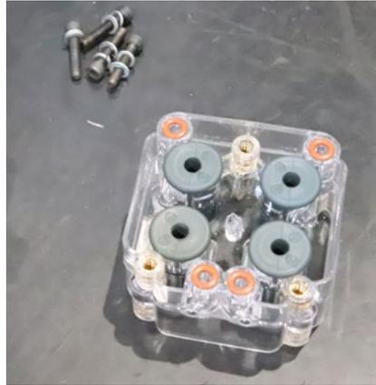
Die vier Quetschventile in einer HDLV-Pumpe müssen nur selten gewechselt werden.
