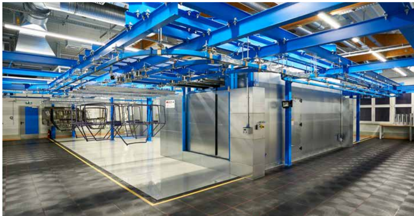
Blick in die Fertigung. Die Anlage umfasst u.a. eine Taktvorbehandlungsanlage mit zwei Kammern und eine Großraumpulverkabine. Fotos: Afotek
